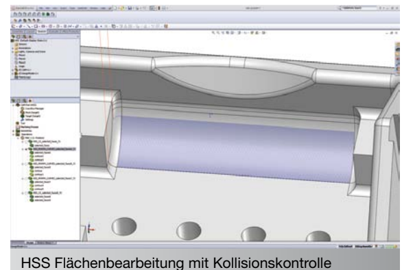
HSS Flächenbearbeitung mit Kollisionskontrolle
